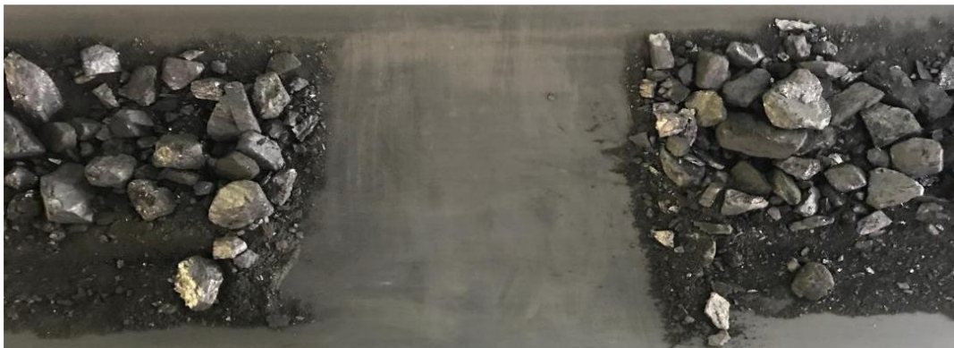
Рисунок 22 – Отбор проб с конвейерной ленты транспортёра
