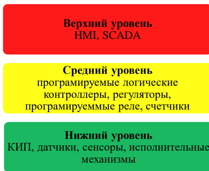
Рисунок 26 – Схема иерархии архитектуры АСУТП ПВ БМЗ
