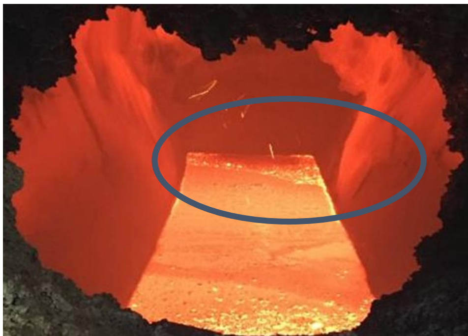
Рисунок 12 – Скопившийся уголь на поверхности шлака под аптейком
