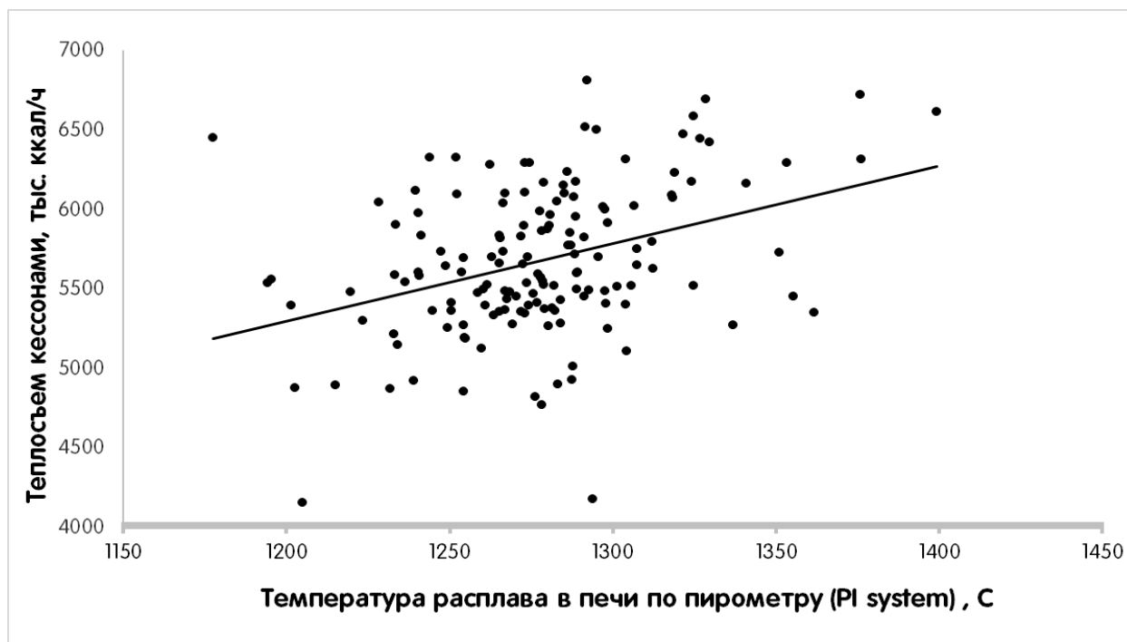
Рисунок 11 – Взаимосвязь между показаниями пирометра и величиной общего теплосъема кессонами в первый период испытаний
